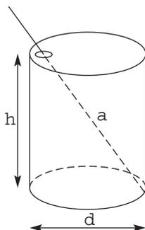
Рис. 28. Метод Кеплера определения ёмкости винной бочки одним измерением:
