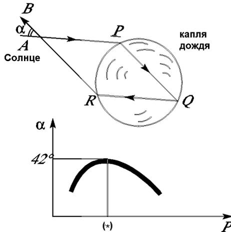
Рис. 30. Обоснование теории радуги Декарта: угол  $\alpha$  отклонения луча  $APQR$  (созданного преломлениями в  $P$ ,  $R$  и отражением в  $Q$ ) гладко зависит от точки  $P$  и достигает максимума в  $42^\circ$
