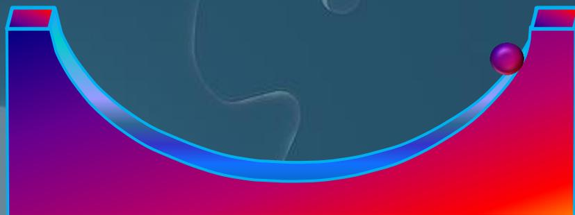
Была предложена конструкция: в доске вырезается желоб в форме циклоиды. По нему катится шарик. Трение отсутствует.
